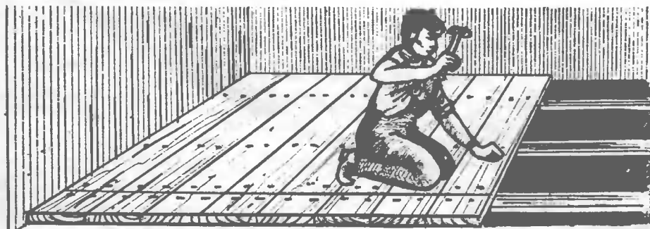
Рис. 6. Настилка чистого пола по лагам.
